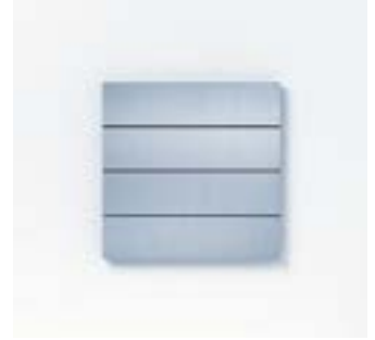
OSB 0004 E Plaquette d'orientation en acier inoxydable, en quatre parties, pour le marquage personnalisé. La surface en acier inoxydable brossé est composée de quatre zones de marquage de même taille et peut être marquée au laser, par film, gravure ou sérigraphie. Zone de marquage (mm) l x H : 154 x 37,75 Dimensions (mm) l x H x P : 154 x 154 x 11
