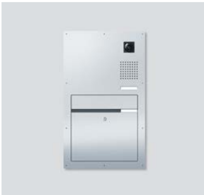
GU CL BF3V130 01 B-0 Boîtier pour le montage encastré en tôle d'acier galvanisée à chaud. Pour chaque façade, il est nécessaire de commander un boîtier adapté. Dimensions (mm) l x H x P : 446 x 762 x 175
