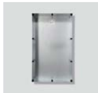
GU CL BF3V130 01 B-0 Boîtier pour le montage encastré en tôle d'acier galvanisée à chaud. Pour chaque façade, il est nécessaire de commander un boîtier adapté. Dimensions (mm) l x H x P : 446 x 762 x 175
