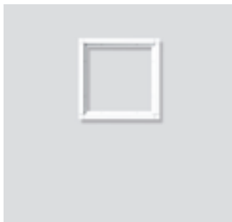
KR 611-2/2-0 Cadre combiné en profilé d'aluminium extrudé, revêtu à la poudre ou peint, entoure les modules de fonctions et masque la gorge d'enduit. Un joint d'étanchéité périphérique empêche la pénétration d'eau. Dimensions (mm) l x H x P : 231 x 231 x 15
