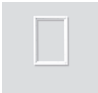
KR 611-3/2-0 Cadre combiné en profilé d'aluminium extrudé, revêtu à la poudre ou peint, entoure les modules de fonctions et masque la gorge d'enduit. Un joint d'étanchéité périphérique empêche la pénétration d'eau. Dimensions (mm) l x H x P : 231 x 331 x 15
